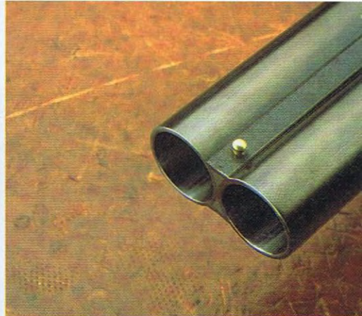
Sopra: particolare della volata con mirino dorato
