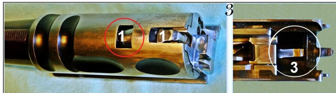
(Fig.1 e 2) - L'otturatore è dotato di un rampone mobile (1), spinto verso l'alto da una molla a spirale (2).
