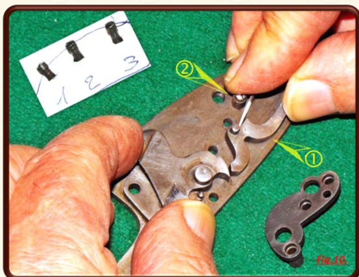
Fig.10. E' importante non cambiare la posizione delle viti; infilarle in un pezzo di carta e segnarle.
