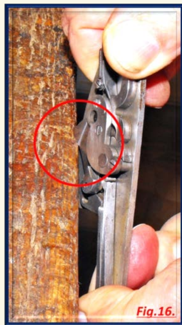
Fig.16. Per armare il cane, si adopera lo spigolo del banco.
