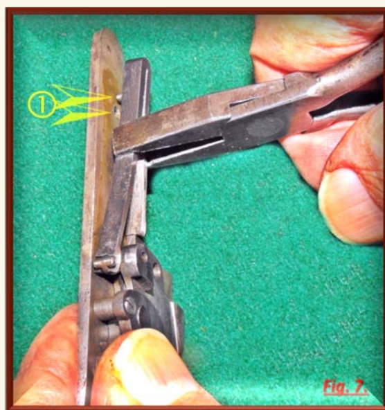
Fig. 8. Tenendo la molla salda sul panno, si apre la pinza. La molla non salta chissà dove.
