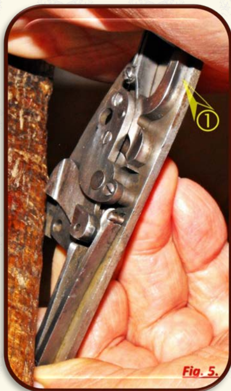
Fig. 5. Per scaricare il cane, si appoggia saldamente la sua testa sullo spigolo del banco e si aziona la stanghetta (1). Entrambe le stanghetture, se sono due; cfr. fig. 12.
