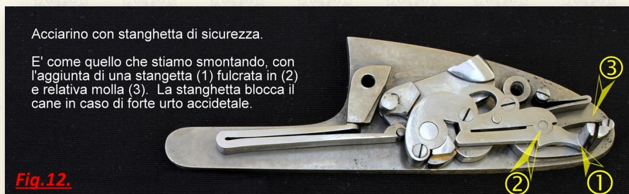
Fig.12. Un diffuso acciarino, noto come <tipo Holland & Holland >.
