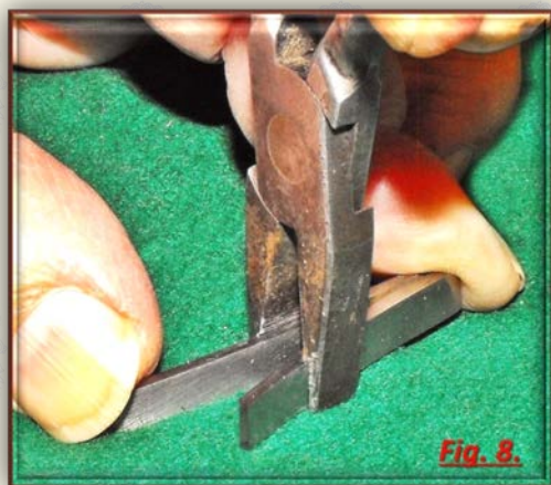
Fig. 8. Tenendo la molla salda sul panno, si apre la pinza. La molla non salta chissà dove.
