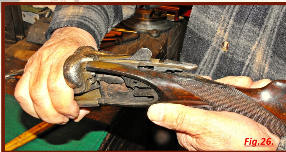
Fig.26. Bascula e calcio si separano.
