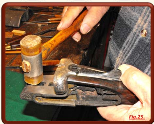
Fig.25. Un colpo di martello avverte il pollice che la codetta si è staccata dal calcio.
