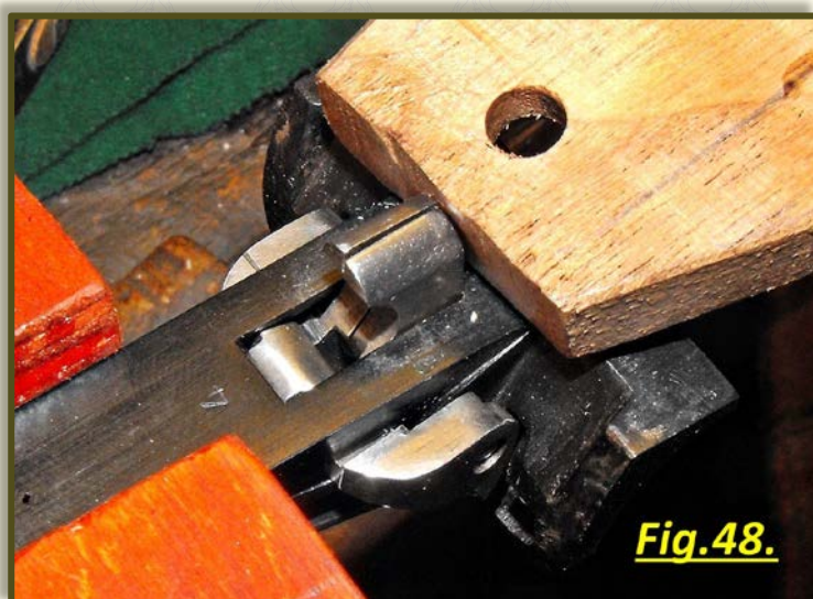
Fig.48. Rimontato il meccanismo, si devono armare i martelli, altrimenti l'asta non si aggancia alle canne. Per vincere la forza delle molle, conviene immorsare la croce, appoggiare un legno sulla testa dei martelli e spingere con forza. E' più agevole caricare un martello alla volta.
