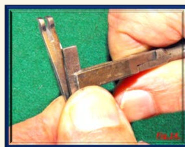
Fig.14. Per poter chiudere la molla, la si afferra fra pollice e indice. La pinza trova, così, un appoggio sulle dita e non scivola lungo la molla.
