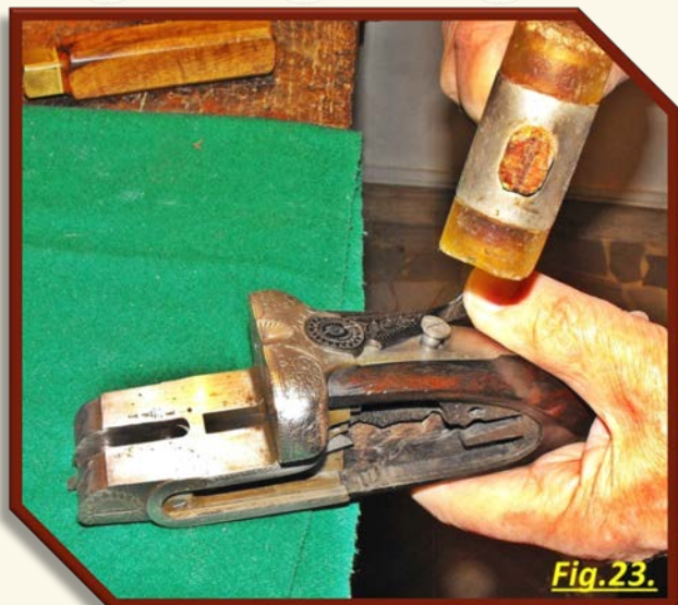
Fig.23. Tenendo aperta la chiave, con il pollice (o con il legno nella mortasa anteriore), si rimonta la vite principale e la si avvita per un paio di giri. Un colpetto sulla testa della vite rimuoverà il ponticello sottostante.
