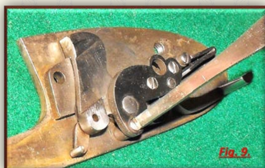
Fig. 9. Ora si possono togliere le viti che serrano la briglia. Qui sono tre, in altri acciarini quattro, a volte una è anche perno della stanghetta di scatto. La sostanza non cambia.
