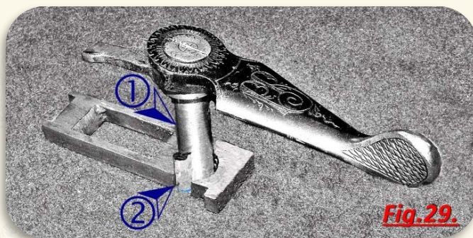
Con un pilastro lungo (1) inserito in un'asola del catenaccio (2). Fig.28-29.
