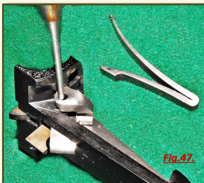
Fig.47. Tolte le molle, si sfila il perno dei martelli che, liberi, possono essere estratti dalla croce.
