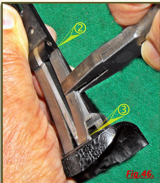
Fig.46. La molla, compressa dalla solita pinza, si sfila dall'incastro (2). Il martello deve essere scarico.
