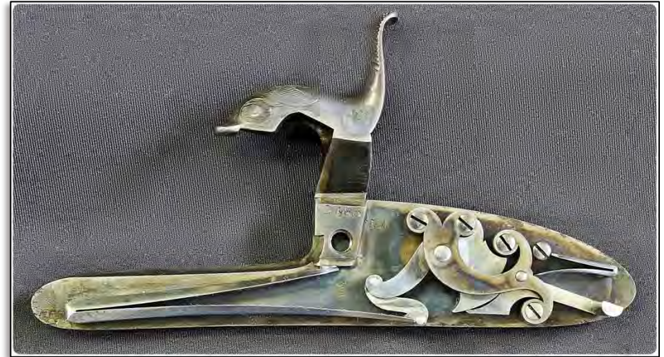
Acciarino di Westley Richards. 1860c.a, senza rimbalzo del cane.
