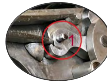
(5). Cane scarico. Il perno (1) ha spinto fuori dalla bascula l'asta, che farà, così, scattare l'estrattore.
