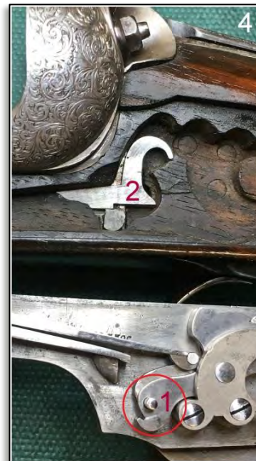
(5). Cane scarico. Il perno (1) ha spinto fuori dalla bascula l'asta, che farà, così, scattare l'estrattore.
