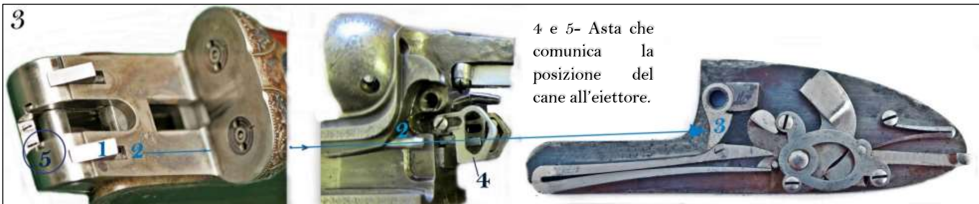
Fig.3- Richiudendo le canne, la rotazione di 1 fa arretrare l'asta 2, che, spingendo su 3, comprime la molla. Il cane è pronto per sparare.
