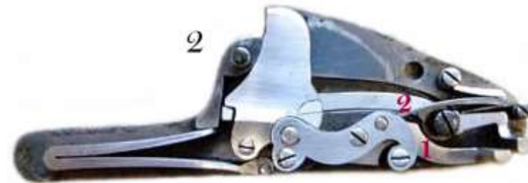
Fig.1- La rotazione delle canne muove la leva (1), che arma il cane spingendo dall'alto verso il basso.
