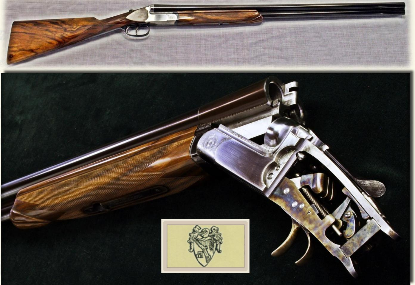
*Versione spartana del tre canne, con accorgimenti volti alla riduzione del costo. Canne con monobloc, bascula, ponticello e meccanismi disegnati in funzione di una razionale "semplicità" costruttiva.*
