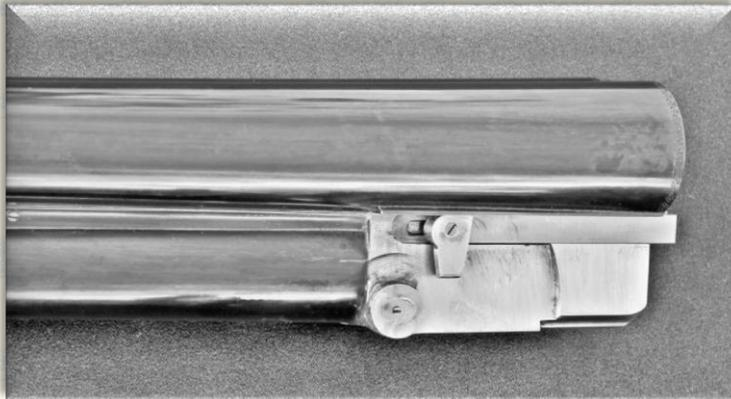
*La ramponatura della tripletta Cortesi si differenzia da quella degli altri costruttori di fucili con tre canne. I ramponi, ricavati dal pieno della canna inferiore, sono posti sui fianchi di quest'ultima. Grazie a questa soluzione, abbiamo una bascula più bassa di*
