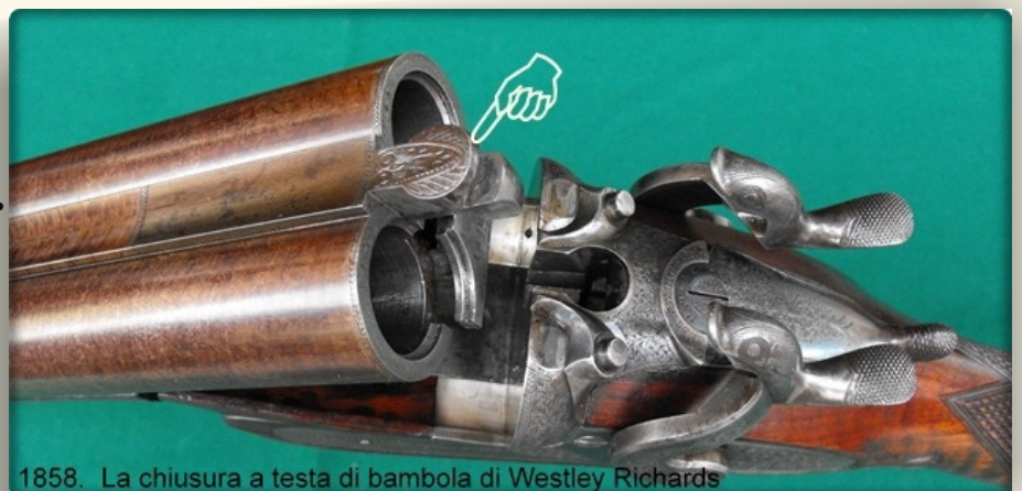
1858. Westley Richards. Realizza la chiusura a testa di bambola.
