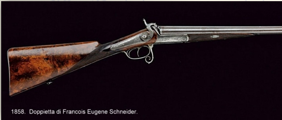
1858. Francois Eugene Schneider. cane esterni, cartuccia con innesco al centro del fondello. Nasce la doppietta moderna.
